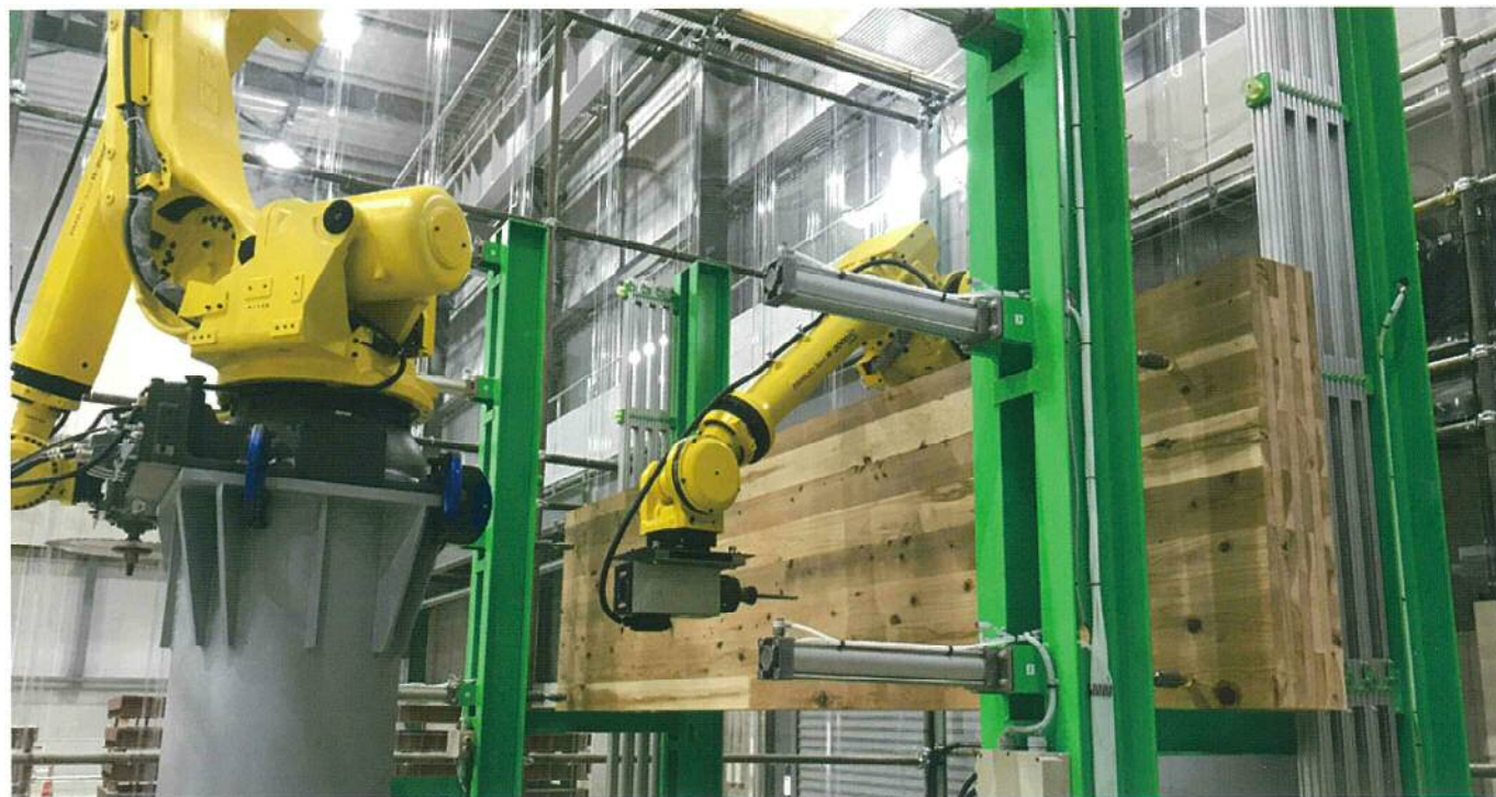
構造材の自動加工をする2台のロボット
